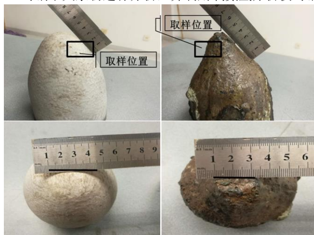
图 1 新塞棒头与旧塞棒头侵蚀形貌
