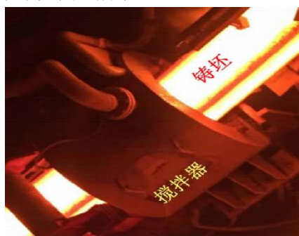
图 5 新型螺旋电磁搅拌器工业应用效果
