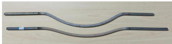
图 15 \phi 8.0mm0Cr21Al6Nb（上）、HRE（下）测试 150 小时后样品对比
