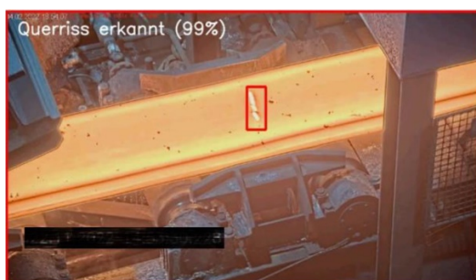
图2 粗轧机出口侧存在质量缺陷的带钢示例 数字助理检测到这些缺陷并向操作工特别提醒
