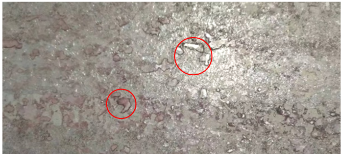
图 2 钢板表面氧化铁
